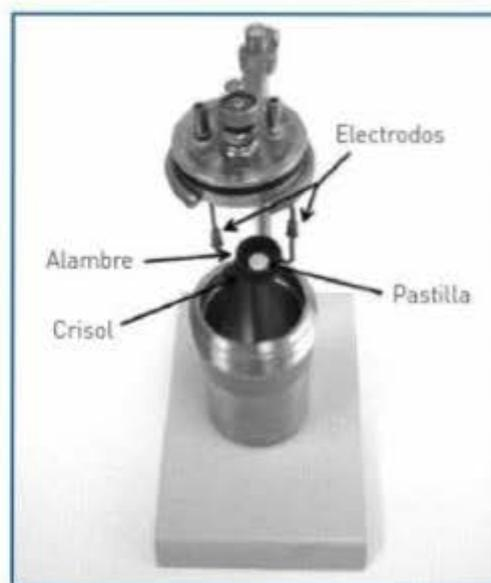
Figura P1-2. Bomba calorimétrica.
