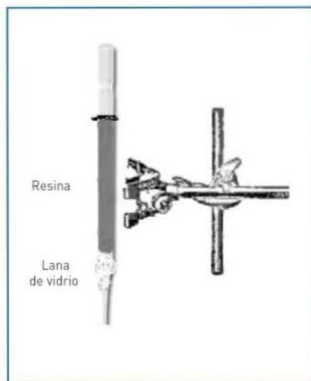
Figura P9-1. Montaje de la columna de resina AG1-X8.
