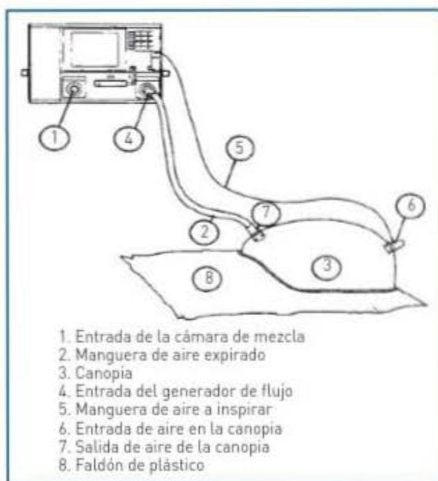
Figura P21-3. Elementos del equipo de calorimetría indirecta.
