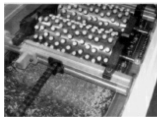
Figura 22. Equipo de desgaste mecánico de superficies deportivas de césped artificial (LISPORT).
