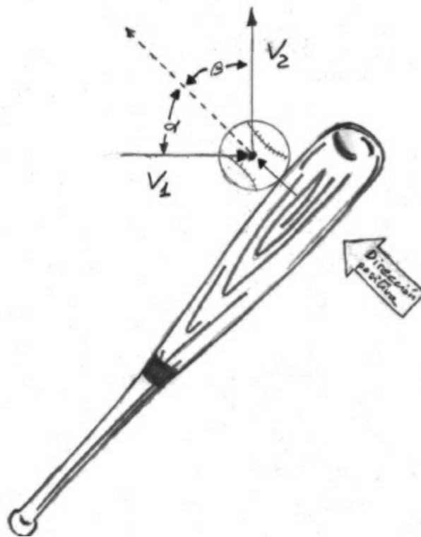
Figura 18. Efecto del impacto de un complemento deportivo con un objeto. (Adaptado de Hay, 1993.)
