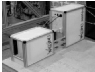
Figura 9. Instrumento Wassing Sestée para la medición del bote angulado de la pelota en el pavimento.
