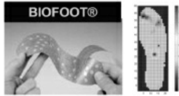
Figura 9. Izquierda: plantilla flexible del Biofoot-IBV. Derecha: representación gráfica de la presión.
