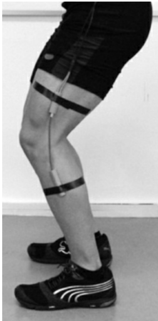
Figura 21. Electrogoniómetro para medir la angulación de la rodilla.
