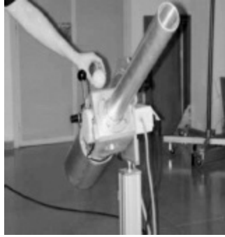
Figura 6. Cañón neumático adaptado a las pelotas de juego de pelota vasca a mano.
