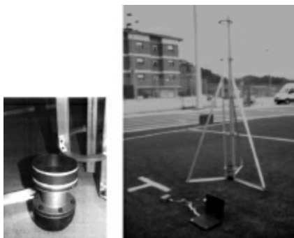
Figura 17. Impactador del equipo de ensayo de HIC y estructura de ensayo.
