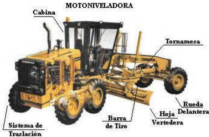
FIGURA 11-1: Partes Motoniveladora
