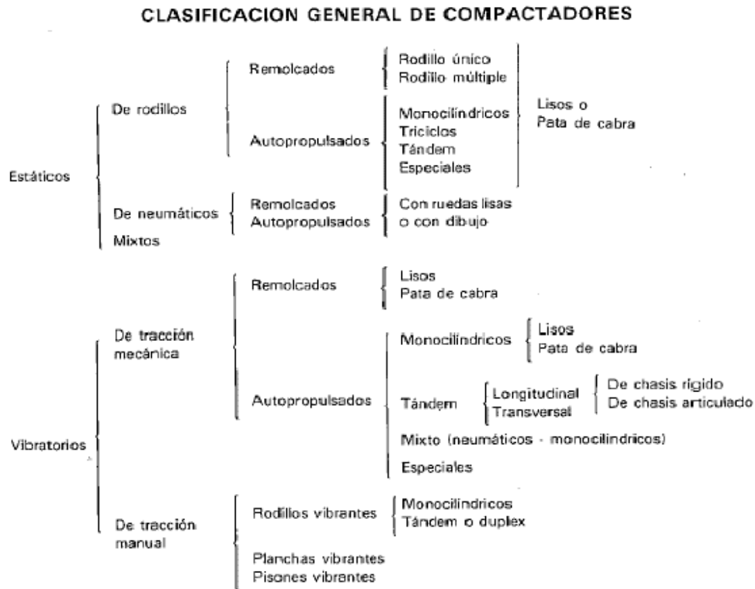
FIGURA 10-2: Clasificación general de Compactadores
